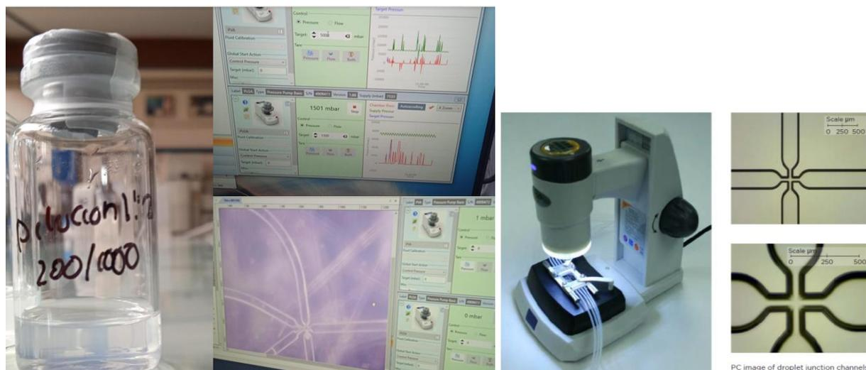
**Figura 7. Obtención de micelas lipídicas en solución coloidal. Microchip de 5 vías y microscopio digital de alta velocidad para el monitoreo de las soluciones durante la formación del flujo laminar.**
